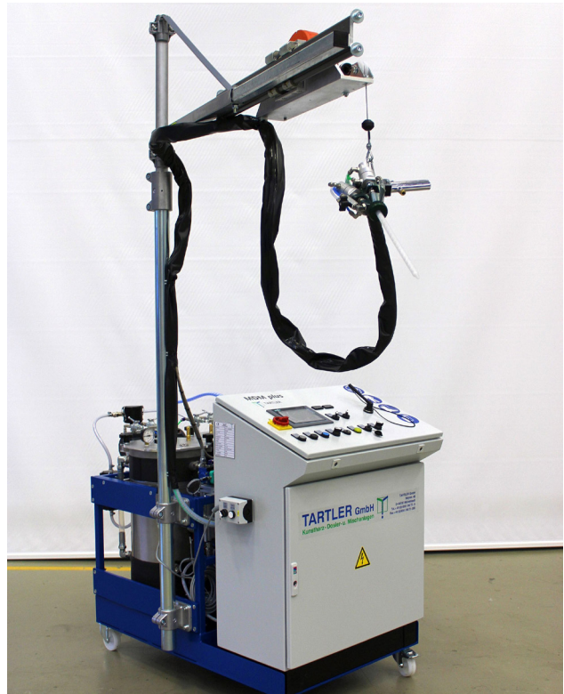
Inklusive Mischkopf-Balancer: TARTLER stimmt fast jede MDM plus auf die Wünsche der Kunden ab – bei Bedarf auch mit handhabungstechnischer Peripherie.
