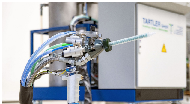
Zur Standardausführung der MDM plus gehört der Mischkopf LC5/3 von TARTLER, der sich mit rotierenden Einwegmischern aus Kunststoff bestücken lässt.
