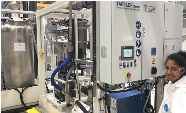
Serienmäßig verfügt die T-EVAC von TARTLER über eine Siemens SPS (7-Zoll-HMI-Bildschirm), ist für die Konditionierung von Epoxid- und Polyurethanharzen ausgelegt und erreicht Entgasungskapazitäten von bis zu 1.000 l/h.
