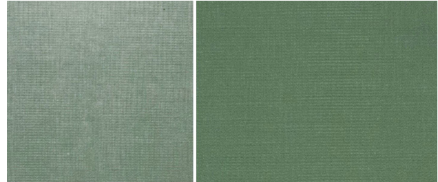
Sichtbar besser: Links eine Faserverbund-Paneele, bearbeitet mit nicht entgastem Material (schwache, ungleichmäßige Materialverteilung). Rechts eine Faserverbund-Paneele, die mit in der T-EVAC entgastem Material getränkt wurde (gleichmäßige, intensive Materialverteilung).
