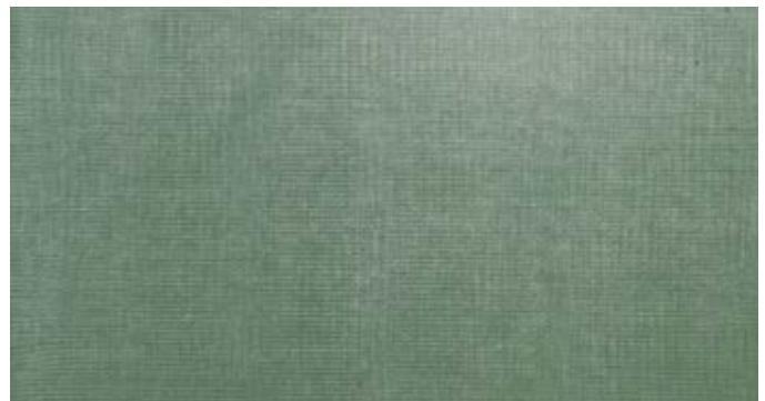
Ergebnis ohne Entgasung: sichtbare Lufteinschlüsse (helle Verfärbung)
