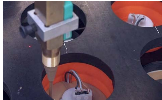
Ein 6-Achs-Cobot führt den Mischkopf mit der Austrittsdüse präzise über einen zugeführten Werkzeugträger und identifiziert, welche Positionen mit in Formschalen befindlichen Bauteilen bestückt ist.
