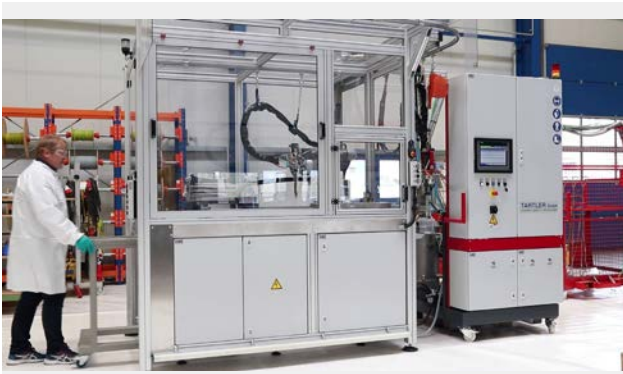
Die Roboterzelle der Elektroverguss-Station hat ein pneumatisches Tor zum Ein- und Ausfahren eines Werkstückträgers, Sensoren zur Abfrage von Distanzen und Positionen sowie Fenster, die eine einfache Zugänglichkeit der Anlage ermöglichen.
