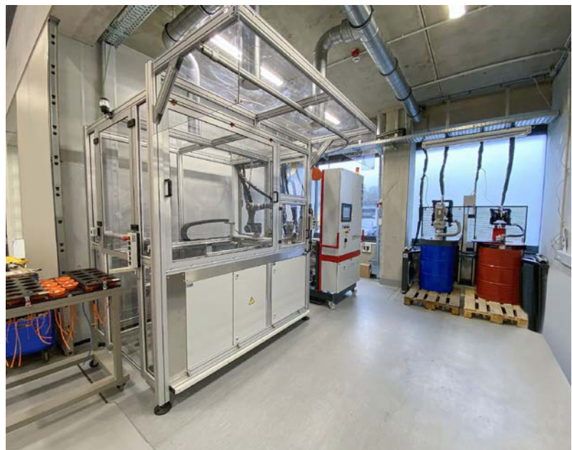
Realisiert von den Unternehmen der TARTLER GROUP: Vollautomatische Systemlösung aus Dosier- und Mischanlage, Vergussstation und Nachfülleinheit.
