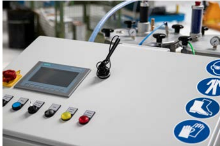
Ausführungsbeispiel einer MDM plus mit Touchpanel.
