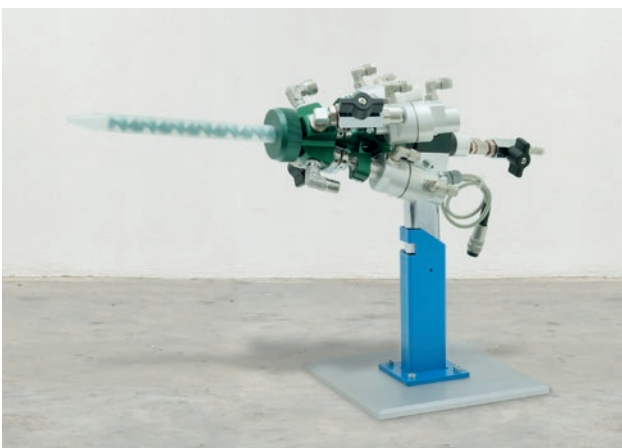
Weltweit bewährt: TARTLER-Kunstharz-Mischkopf LC 5/4 zur Verarbeitung von bis zu vier Komponenten mit aufgesetztem Einwegmischer (Hakenlösung).
