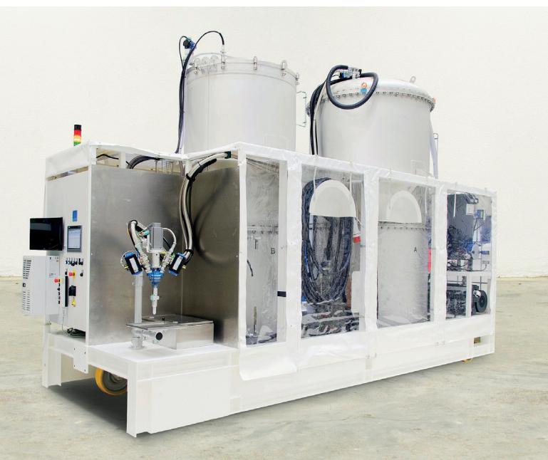
Innovative Komplettlösung für die Direktinfusion: Nodopur-Anlage mit Inline-Entgasungsstation T-EVAC von TARTLER.
