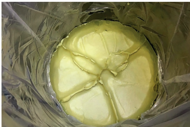
Selbst bei einem sorgfältig geleerten Fass verbleiben bis zu 14 kg Harzreste in dessen Inliner. Sie lassen sich mit der TAVA 200 F von TARTLER aufbereiten und in den Verarbeitungsprozess der Rotorblatt-Produktion zurückführen.
