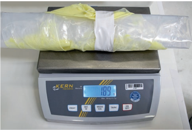
Alles was nach dem Einsatz der TAVA 200 F und der Inliner-Auspresseinheit von TARTLER übrigbleibt: Ein eingerollter Foliensack mit minimalen Harzresten.
