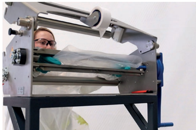
Ergänzend zu seiner Entgasungsstation TAVA 200 F bietet TARTLER eine mobile Auspresseinheit, mit der sich die letzten Harzreste aus dem Inliner herausdrücken und in einem Fass auffangen lassen.
