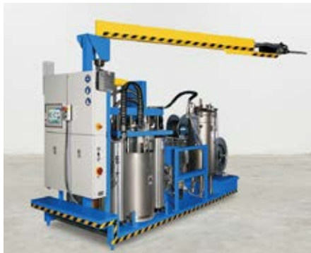
Ausführungsbeispiel einer volumenstromgeregelten TARDOSIL mit autom. Nachfüllung für A und B
