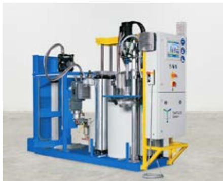
Ausführungsbeispiel einer TARDOSIL mit 200 l Behälter (A) und 30 l Drucktank (B) mit autom. Nachfüllung
