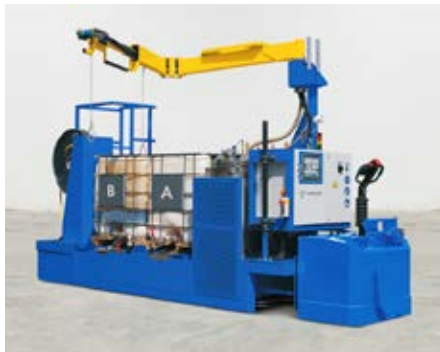
Ausführungsbeispiel einer volumestromgeregelten NODOPUR mit Handlingarm und eigener Antriebseinheit
