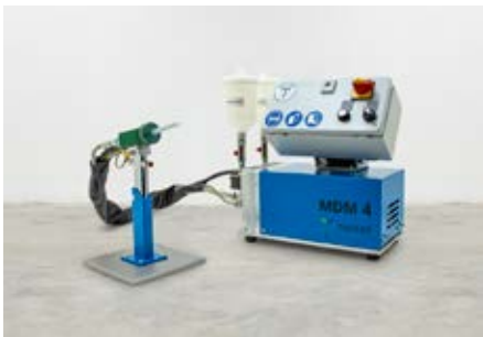
Ausführungsbeispiel einer MDM 4 mit 0,6 l Kunststoffbehältern
