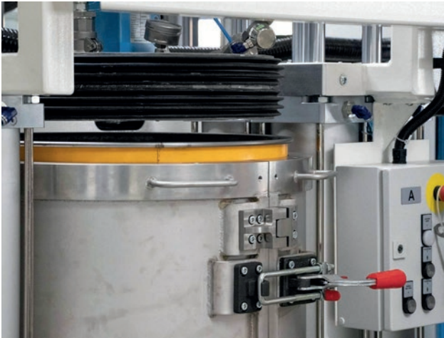
Fasswechselsystem TAVA D in einer Nodopox: Im Fass wird ein Vakuum (-0,97 bar) erzeugt, sodass beim Fasswechsel keine Luft in die Dosier- und Mischanlage eindringen kann. Materialverlust und Spritzgefahr sind nahezu ausgeschlossen.
