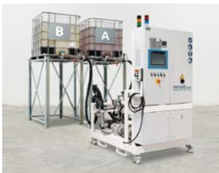
Ausführungsbeispiel einer NODOPUR mit gravimetrischer Nachfüllung aus IBC im freien Zulauf (free flow)
