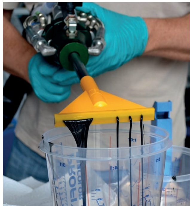
Wer flüssige Kunstharze in dünnen Schichten bahnförmig applizieren will, findet im Zubehörprogramm von TARTLER spezielle Breitstrahldüsen in verschiedenen Varianten.
