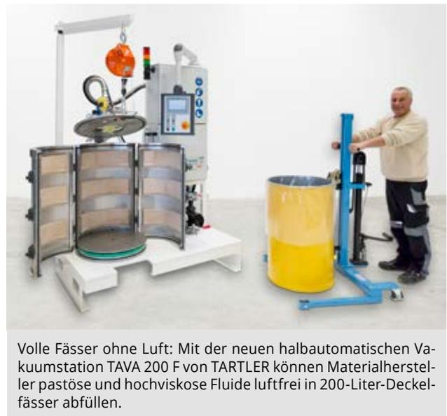
Volle Fässer ohne Luft: Mit der neuen halbautomatischen Vakuumstation TAVA 200 F von TARTLER können Materialhersteller pastöse und hochviskose Fluide luftfrei in 200-Liter-Deckelfässer abfüllen.
