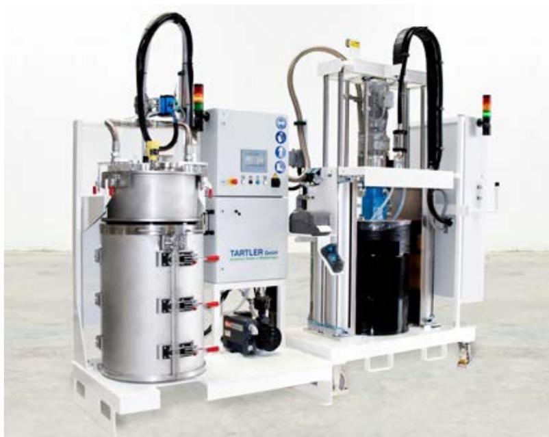
Innovative Lösung für Materialhersteller: Mit der Systemlösung TAVA 200 F mit Nodopox 200 1K zeigt TARTLER auf der Bondexpo und der Fakuma eine vielseitig einsetzbare Vakuumstation, mit der sich hochviskose und pastöse Medien ohne Störluft in Deckelfässer abfüllen lassen.
